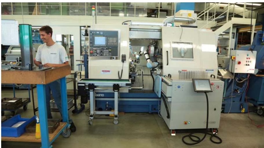
Ohne Schutzzaun und auf wenig Raum: Die Bachmann Feedmaster legt ein unbearbeitetes Teil ein.
